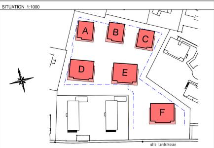
Haus E = ± 0.00 = 428.65 Meter über Meer = Oberkant fertig Boden Treppenhaus Erdgeschoss
